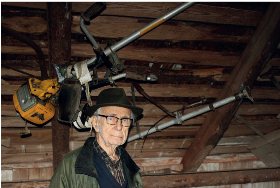
Jouko Juurikkala ja kaksi lukuisista vuosikymmenten mittaan käytössä olleista raivaussahoista. Taaimpana vuonna 1959 käytössä olleen raivaussahan teräosa. Voimanlähteenä oli moottorisaha. Sahasta poistettiin terälaippa ja näin saatiin ulosotto voiman siirtämiseksi raivaussahan terään.
